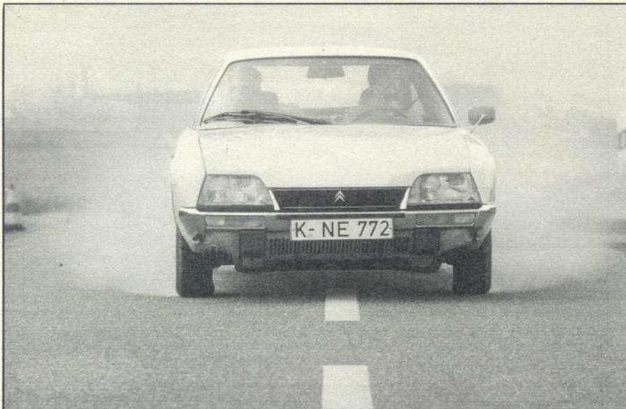
Bei der Vollbremsung hält der Citroën ohne Komplkation die Spur. Der Bremsweg ...
