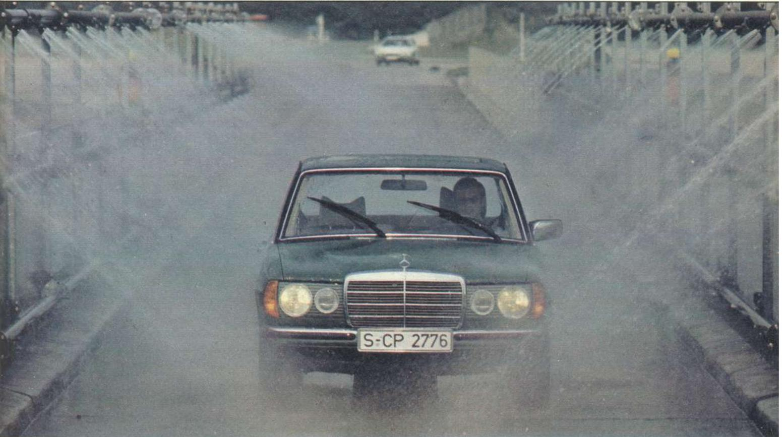
Test im Sprühkanal: Wie gut sind Scheibenwischer, wie dicht ist die Karosserie ...
