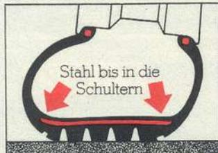
Der überbreite Stahlgürtel stabilisiert die Lauffläche
