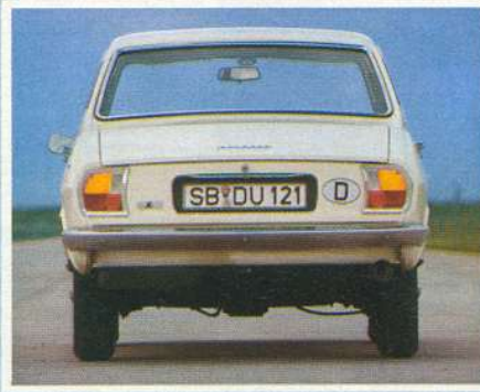
Die Starrachse verrät den 504 L
