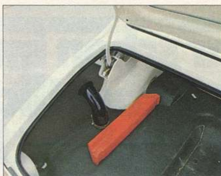
Die Starrachse kostete Kofferraumgröße
