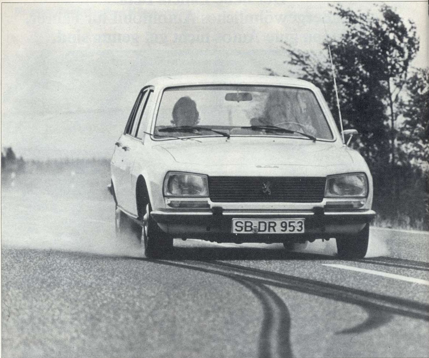
Ausgesprochen spurtreu verhält sich der Peugeot 504 Diesel beim Bremsen aus 100 km/h. Überdurchschnittlich ist die Bremswirkung:
