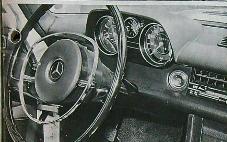
Sur la planche de bord de la 220 D (en haut), on remarque la tirette du préchauffage et le témoin lumineux. Cette commande, en tirant, actionne le démarreur. En la repoussant, elle permet l'arrêt du moteur.
