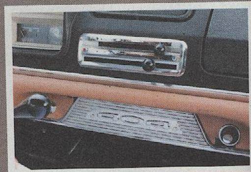
↑ Le chauffage se règle facilement: position fermée avec la manette à gauche et ouverte à droite. Par temps très froid, la totalité de l'air chaud peut être envoyée vers le pare-brise en fermant deux trappes situées en dessous du logo 404.
