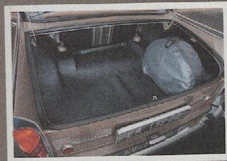
Profond, le coffre est à bonne hauteur pour ne pas se donner un tour de reins et sa contenance permet d'accueillir plusieurs sacs et valises. Dommage que la roue de secours, disposée verticalement dans une housse, occupe une si grande place.
