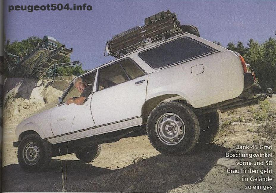
Dank 45 Grad Böschungswinkel vorne und 30 Grad hinten geht im Gelände so einiges
