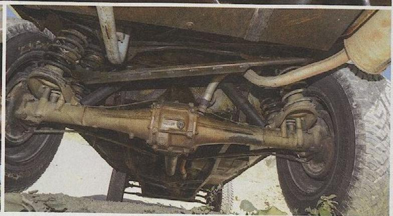
Dank Zusatzrahmen mit ordentlicher Bodenfreiheit gesegnet: Die nun als Vorderachse fungierende Peugeot-604-Hinterachse (links) sowie die Hinterhand mit ihren doppelten Schraubenfedern (rechts) sind auch ohne Hebebühne gut inspizierbar
