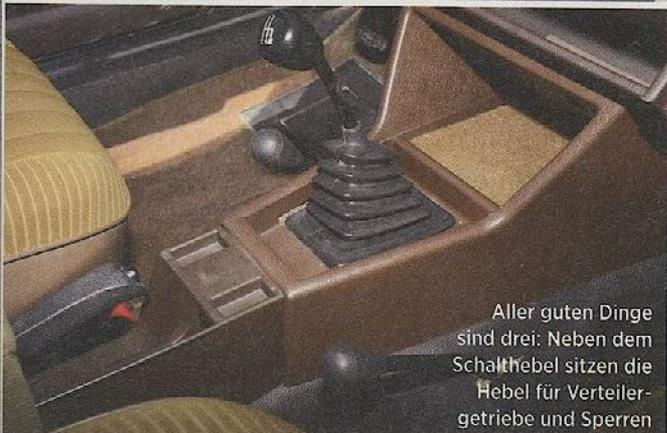
Aller guten Dinge sind drei: Neben dem Schalthebel sitzen die Hebel für Verteilergetriebe und Sperren
