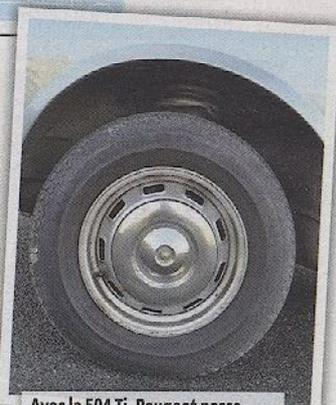
Avec la 504 Ti, Peugeot passe aux "175". Les jantes en tôle pouvaient être remplacées par des alliages de marque Dunlop disponibles en boutique Peugeot.
