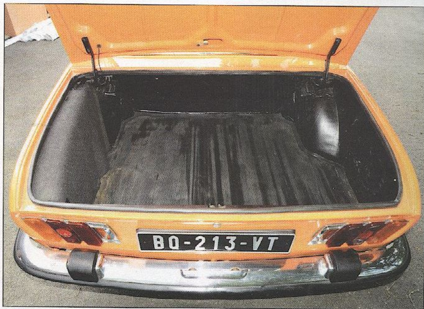
La contenance du coffre à bagages est hors normes pour un cabriolet. Cric et manivelle sont dissimulés derrière l'habillage situé à gauche.
