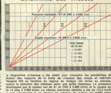
Le diagramme ci-dessus a été établi pour connaître les possibilités de chaque dé rapports de la boîte de vitesses des coupé et cabriolet Peugeot 504 en fonction du régime du moteur. Un levier au plancher assure la sélection des vitesses selon une grille classique. La puissance développée par le moteur est de 97 ch DIN à 5 600 tr/mn et le couple est de 14 kg à 3 000 tr/mn. La vitesse maximale atteinte à dé de 172,4 km/h, ce qui correspond à un régime de rotation du moteur de 5 600 tr/mn.
