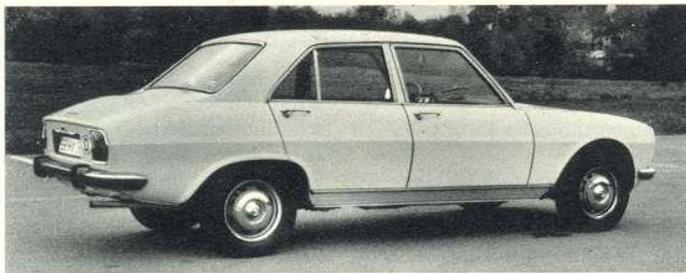
Das hintere Stoßstangen-Mittelteil mit Gummibelag hat der Peugeot 504 schon seit April 1970, kein sicheres Kennzeichen des 504/2000 ab September 1970. Indiz für den stärkeren Motor ist jedoch die jetzt serienmäßige heizbare Heckscheibe.
