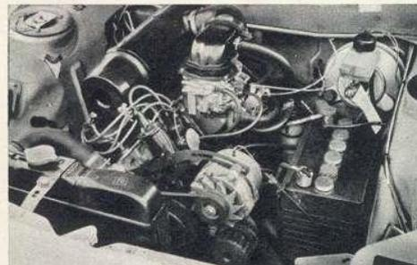
93 PS-Vergasermotor: Sehr gute Zugänglichkeit zu allen Teilen. Rechts vorn die Einstellmöglichkeit der Scheinwerfer nach Wagenbelastung.
