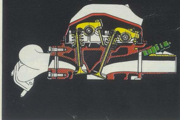
1. Coupe transversale de la culasse et détail d'un injecteur.
