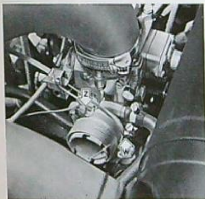
Carburateur Solex 34 PBICA 9 voor de Stationcar
