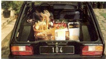
104 ZA - Capacité du coffre 860 dm 3 banquette arrière rabattue
