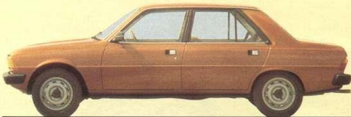
PEUGEOT 305 und 305 GL 1290 ccm, 44 kW (60 DIN PS), 144 km/h Höchstgeschwindigkeit, Einzelradaufhängung, Scheibenbremsen vorn, Bremskraftverstärker, Bremskraftregler, Kurvenstabilisator vorn und hinten.
