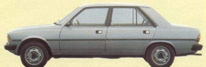
PEUGEOT 305 S 1472 ccm, 65 kW (89 DIN PS), 162 km/h Höchstgeschwindigkeit, Einzelradaufhängung, Scheibenbremsen vorn, Bremskraftverstärker, Bremskraftregler, Kurvenstabilisator vorn und hinten.
