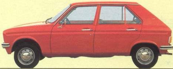
PEUGEOT 104 GL 954 ccm, 33 kW (45 DIN PS), 128 km/h Höchstgeschwindigkeit, Einzelradaufhängung, Scheibenbremsen vorn, Bremskraftregler, Kurvenstabilisator vorn.
