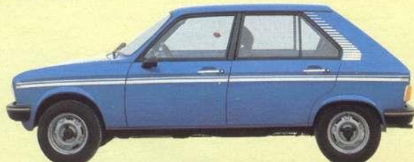
PEUGEOT 104 S 1360 ccm, 53 kW (72 DIN PS), 158 km/h Höchstgeschwindigkeit, Einzelradaufhängung mit Kurvenstabilisator vorn und hinten, Scheibenbremsen vorn, Bremskraftregler und Bremskraftverstärker.
