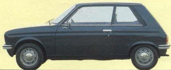
PEUGEOT 104 ZL 954 ccm, 33 kW (45 DIN PS), 128 km/h Höchstgeschwindigkeit, Einzelradaufhängung, Scheibenbremsen vorn, Kurvenstabilisator vorn.
