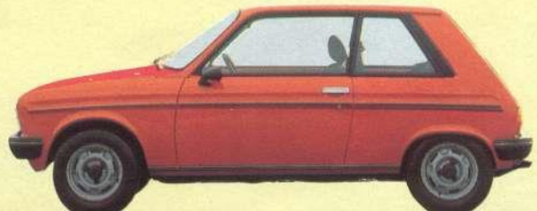
PEUGEOT 104 ZS 1360 ccm, 53 kW (72 DIN PS), 158 km/h Höchstgeschwindigkeit, Einzelradaufhängung, Scheibenbremsen vorn, Kurvenstabilisator vorn und hinten.
