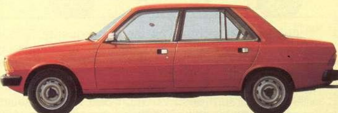
PEUGEOT 305 GLD und 305 SRD 1548 ccm, 36 kW (49 DIN PS), 135 km/h Höchstgeschwindigkeit, Einzelradaufhängung, Scheibenbremsen vorn, Bremskraftverstärker, Bremskraftregler, Kurvenstabilisator vorn und hinten.
