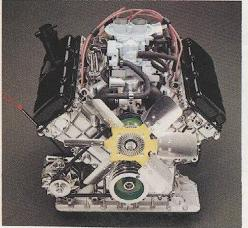
Moteur 6 cylindres en V à 90° -Super carré - Bloc-cylindres en aluminium sous pression -Chemises amovibles humides -Culasse en aluminium à chambres bisphériques - Un arbre à cames en tête par rangée de cylindres -Vilebrequin à 4 paliers -Ventilateur de type glissant.
