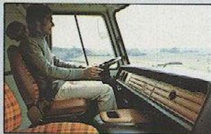
Appui-tête de sécurité, directement fixés à l'armature des sièges.
