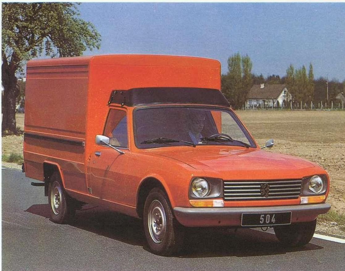
CU : environ 1 050 kg selon la version – Volume : près de 5 m<sup>3</sup> – Longueur intérieure : 2,38 m – Largeur : 1,60 m – Hauteur : 1,32 m – Ossature métallique – Revêtement extérieur en tôle emboutie – Pavillon renforcé pour fixation support échelle – Galerie – Grandes portes AR battantes – Largeur et hauteur d'entrée : respectivement de 1,26 m et 1,24 m.
