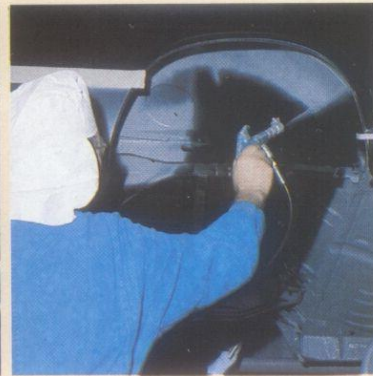
5 OVENGEHARDE PVC COATING: van 1 à 2 mm dik. Beveiligt carrosseriedelen die aan steenslag e.d. worden blootgesteld.
