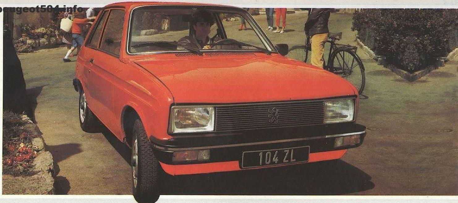
**104** Traction avant à moteur transversal, suspension à 4 roues indépendantes, 5 portes, 5 places, banquette arrière rabattable, moteur en alliage léger à arbre à cames en tête, la 104 réunit en quelques m<sup>2</sup> ce que l'on a inventé de
