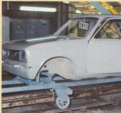
**6.** GRUNDIERUNG: Diese Schicht enthält Pigmente, die oxydationshemmend wirken. Sie sorgen für erhöhten Korrosions- und Steinschlagschutz und verbessern die Haftung der Lackschicht.
