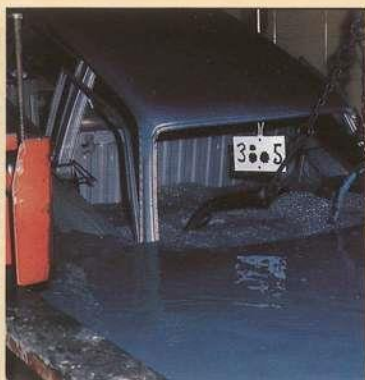
3 CATAFORESEBAD: Aanbrengen van een grondlaag op alle onderdelen van de carrosserie. De holle ruimten zijn van doorstroomopeningen voorzien, zodat ook de binnenkant wordt bereikt.
