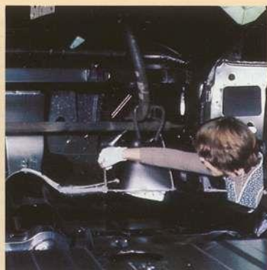
4 WASBEHANDELING: Door drukinspuiting in holle delen. Beschermst binnenwanden en voorkomt dat water tussen de plaatverbindingen dringt.
