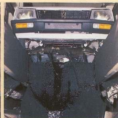
10 MENGSEL VAN DIKKE WAS EN TEER: dit wordt aangebracht aan de onderzijde van carrosserie, wielkasten en ophangingen, waardoor het binnendringen van water en vocht in de holle ruimten wordt voorkomen.
