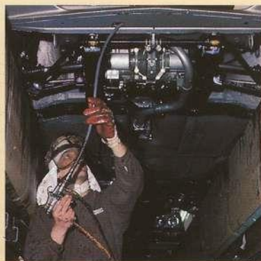
9 UNDERCOATING OP BITUMEN BASIS: Voorkomt binnendringen van water en vocht in holle delen.
