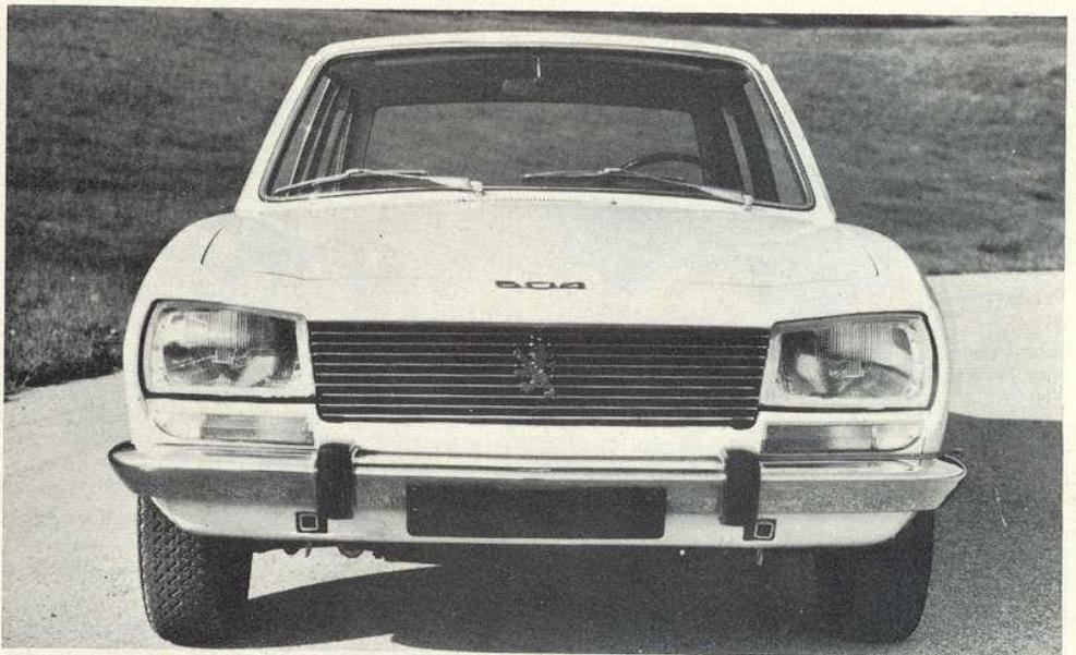
Die „schiefen“ Scheinwerfer enthalten rechteckige Reflektoren, die beim Vergasermodell mit normalen Biluxbirnen, beim Einspritzer zusätzlich mit einer Halogenbirne pro Reflektor bestückt sind.
