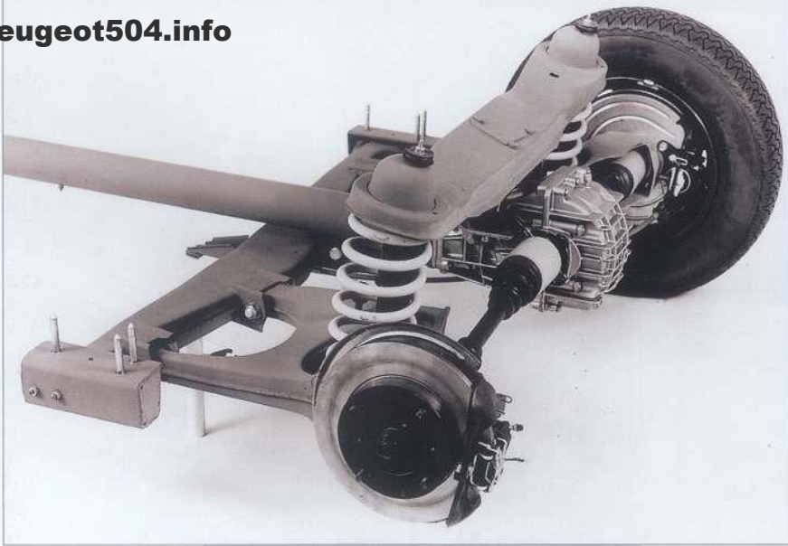
Ci-dessus et ci-dessous. Vue générale et détail au trait du train arrière, équipé comme celui de l'avant d'une barre antidévers. Les bras de suspension sont réalisés en tôle épaisse emboutie ; la conception de ces bras et la disposition des ressorts ont permis de doter la 504 d'un plancher de coffre plat sur toute la surface.
