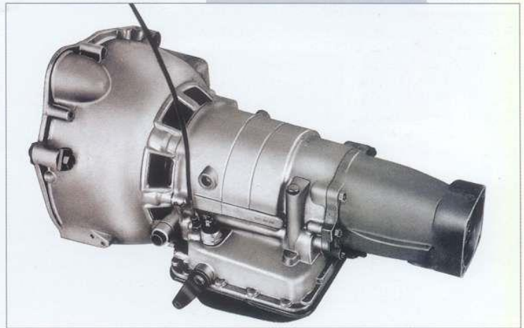
Ci-dessus. La 504 à carburateur peut recevoir sur demande (supplément : 1 500 F) une transmission automatique ZF composée d'un convertisseur de couple, d'une boîte de vitesses à trois rapports avant et d'un bloc de commande hydraulique. Ce dernier, d'un type nouveau, met à disposition du conducteur six positions repérées dans un cadran disposé près du volant : P - Parking. AR - Marche arrière. N - Neutre (point mort). A - Automatique et 1 ou 2. Exceptionnelle (pour routes de montagne ou conduite sportive).
