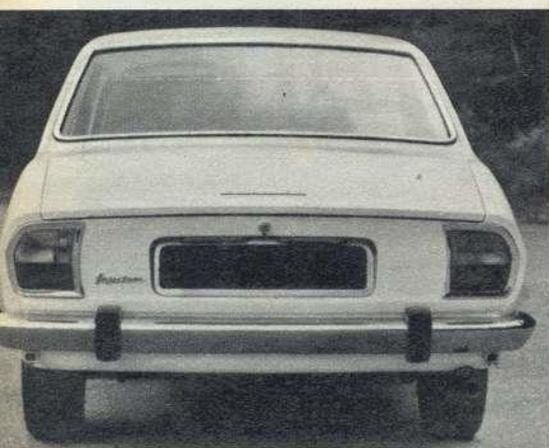
Die kompakte Karosserie zeichnet sich durch eine niedrige Gürtellinie und große Fenster aus (oben). Die wichtigsten Zierteile sind aus nichtrostendem Stahl, die Einspritzversion hat serienmäßig Halogenscheinwerfer. Die Einspritzanlage für den 1,8 Liter-Motor (rechts) stammt von Kugelfischer.
