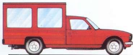
FOURGONNETTE VITRÉE sur base 504 châssis-cabine
