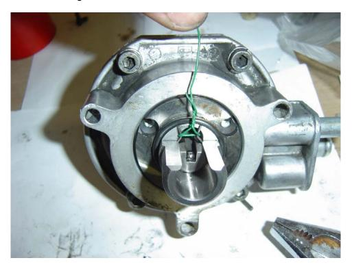
Beim Wiedereinbau ist darauf zu achten, dass der Hebel, welcher im unteren Gehäuseteil auf die Pumpenwelle gesteckt ist, zuerst mit einem Stück Draht soweit als möglich in Richtung Einspritzdüsen gezogen wird. Gleichzeitig muss das obere Gehäusestück mit den Membranen wieder eingefahren und der Draht im letzten Moment herausgezogen werden.
