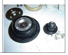
Anschliessend alle Teile in umgekehrter Reihenfolge wieder zusammenbauen und bei Bedarf die sichtbaren O-Dichtungsringe der Pumpe ebenfalls ersetzen.
